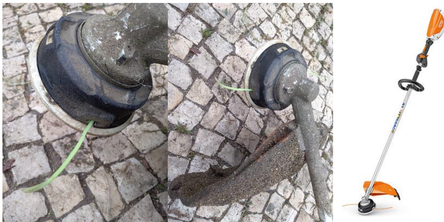
Figura 1 - Roçadora mecânica com fio nylon e cabeça da roçadora
